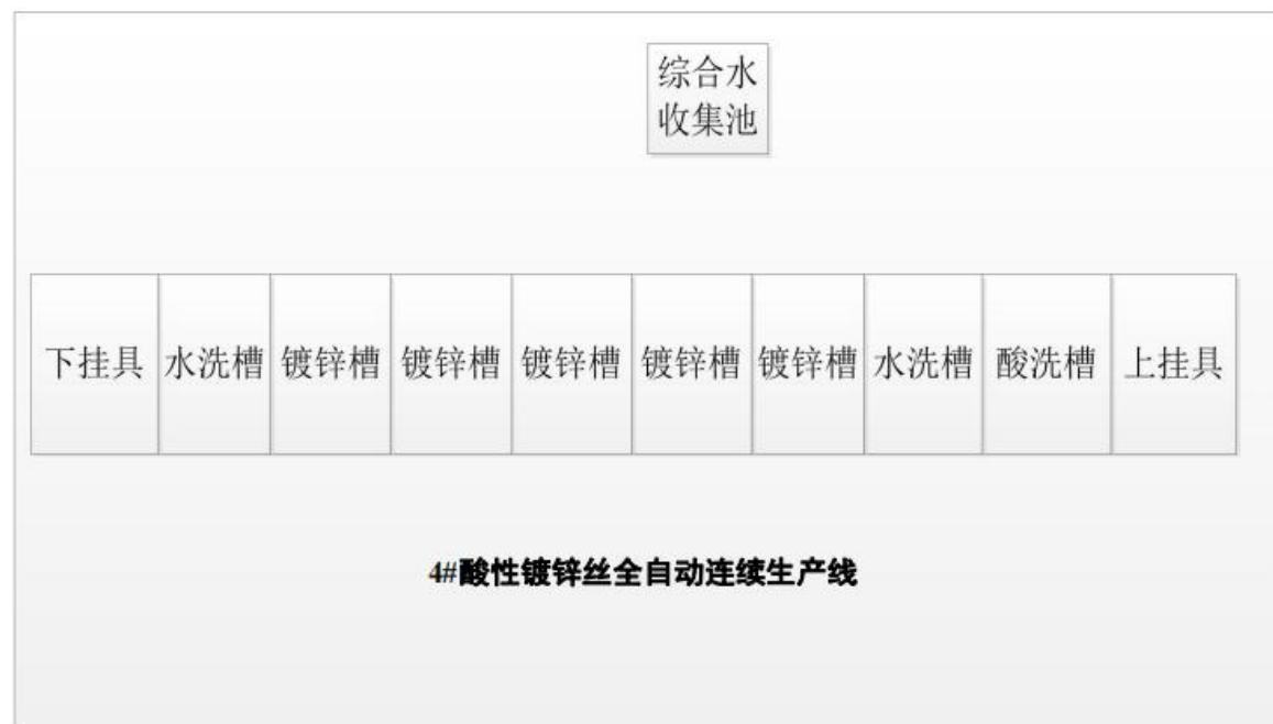
图 3.1-3 电镀车间2平面布置图
