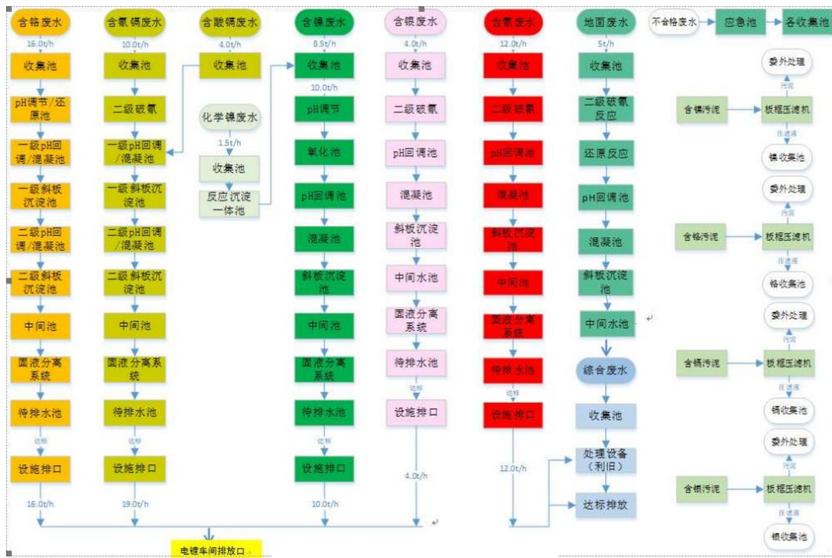
图 5.2-8 污水处理站处理系统工艺流程图
